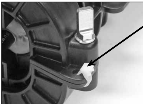
Amarra plástica en orificio del reborde del collar
